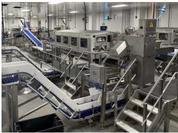
Thiết kế và bố trí cầu thang, sàn thao tác, dây điện đảm bảo vệ sinh
